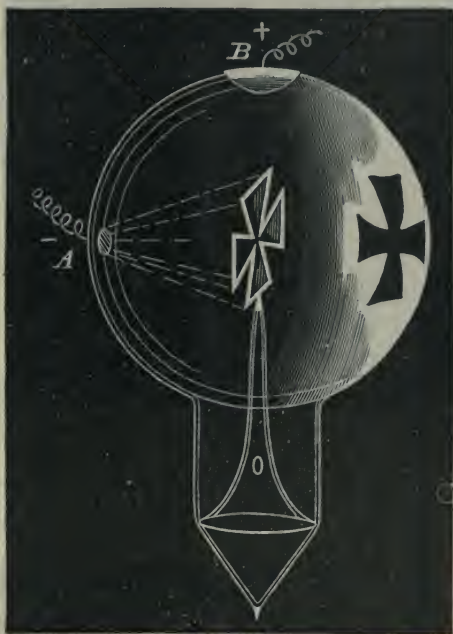
Fig. 679.—“Radiant Matter” Shadow. (External Electrodes.)
